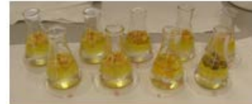
Material absorbente con agua contaminada
